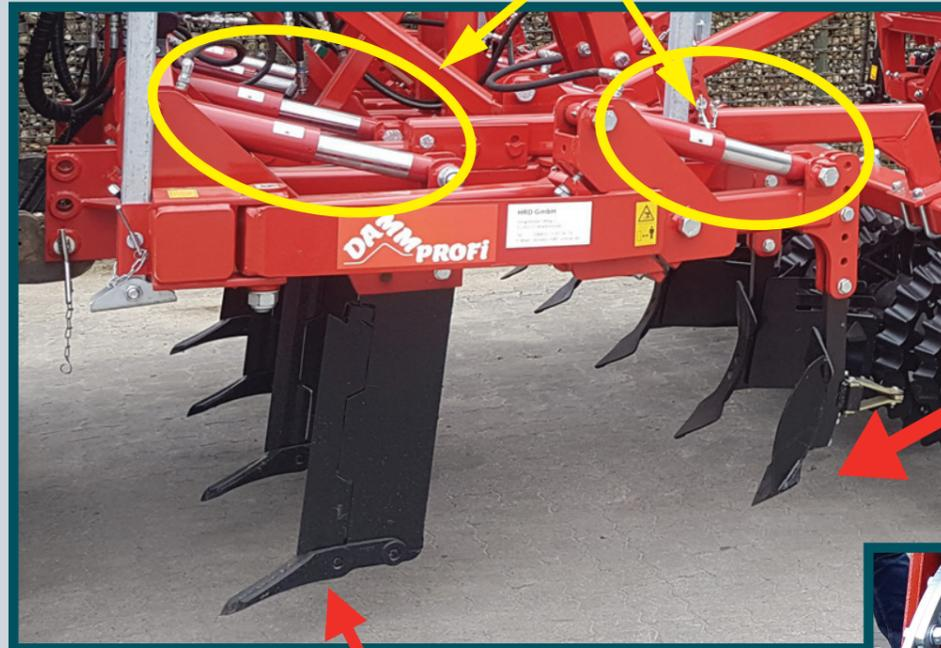
Der Häufelkörper formt die obere, nährstoffreiche Bodenschicht zum Damm, wie es auch aus dem Kartoffelanbau bekannt ist
