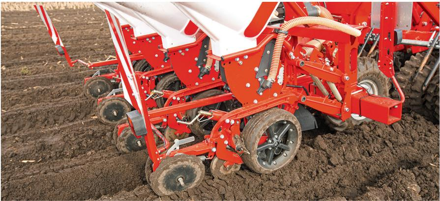
△ Die Säaggregate laufen auf den zuvor geformten Dämmen.
