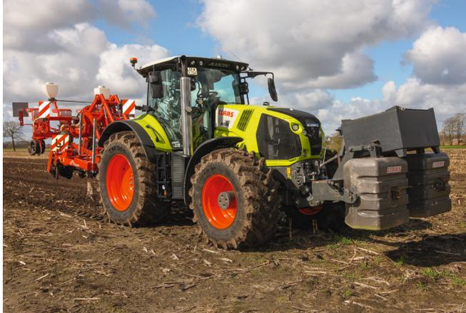
◁ Hebelkräfte aufgrund der langen Bauform des Dammprofils machen ein Frontgewicht unerlässlich.
