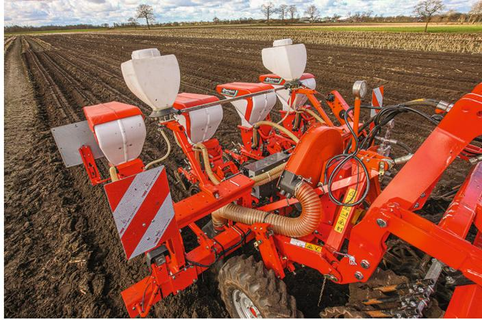
◁ Das Dammverfahren lässt sich gut mit der Mikrogranulatdüngung kombinieren (die beiden weißen Behälter).
