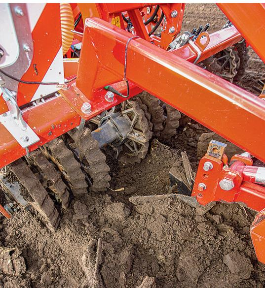
△ Prismenrollen, die hinter den Häufelscharen angeordnet sind, festigen die Dämme.
